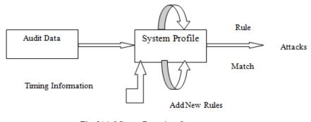
Fig. 2(a). Misuse Detection System.
